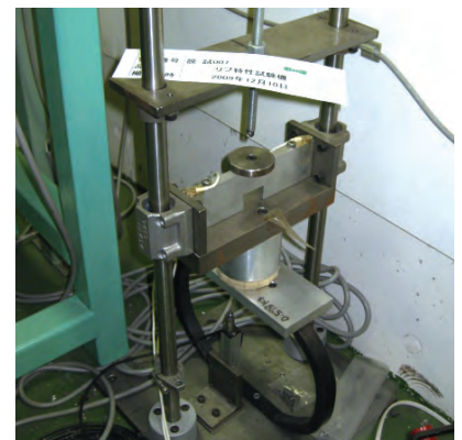
Rib unit test
